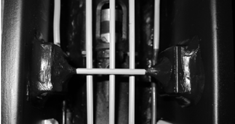
1. Bowdenzug Durchführung mit Kunststoff Stützelementen einkleben
