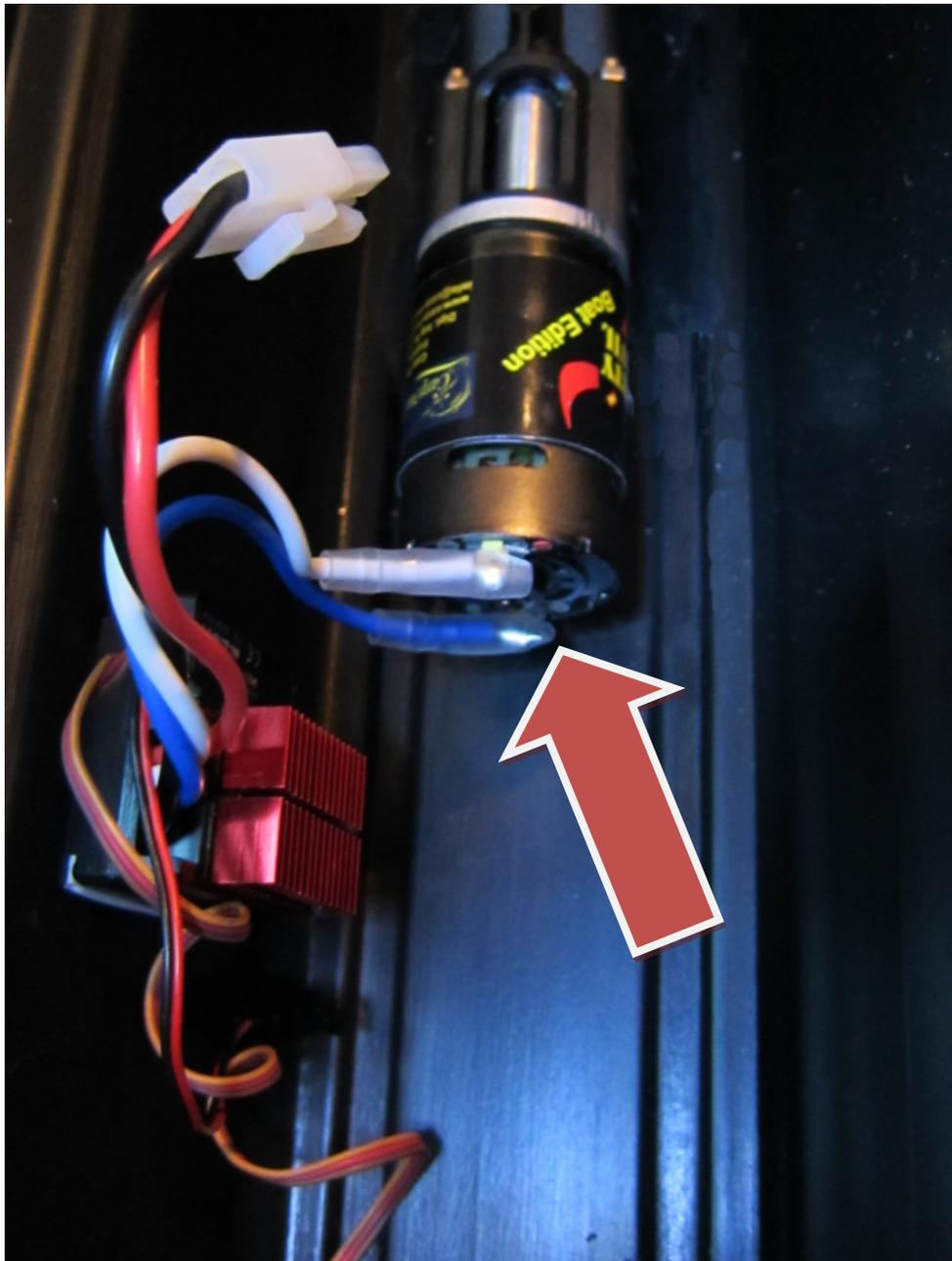
Bevor die weiteren Teile eingebaut werden, sollte man die Motoren laufen lassen. Hierzu steckt man den linken Motor auf Steckplatz 1 am Empfänger und den rechten Motor auf Steckplatz 2. (schwarzes/braunes Kabel nach außen)
