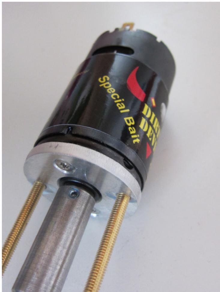
Alle Schrauben, auch die Gewindestangen mit Schraubensicherung einkleben! Die Verbindungshülse muss einen kleinen Abstand (etwa 1-2 mm) zum Motor haben.
