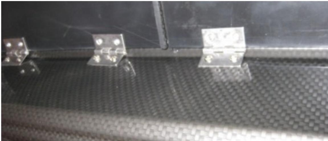
Montage der Klappen (ein- oder zweiteilig). Man sollte bei der Montage darauf achten, dass die Klappen etwas Spiel in der Höhe haben, so bleibt die Schnur der eingelegten Montage frei beweglich. Hierzu kann man als Hilfsmittel vor der Verschraubung einen Abstandhalter von 1 oder 2 mm zwischen Futterklappe und Rumpf legen. Verwenden Sie nur Edelstahl- oder Alubauteile, da diese nicht korrodieren.
