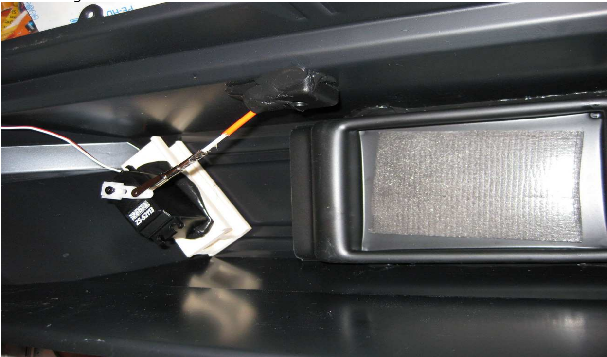
Abbildung : Servobedienung von 1 Futterklappe mit Bowdenzug
